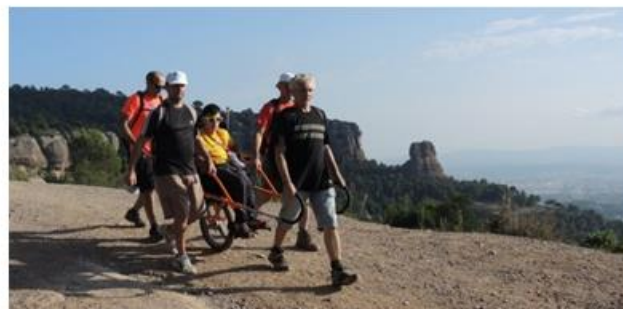
La cadira Joëlète, d'una sola roda, permet que una persona amb mobilitat reduïda pugui fer recorreguts per terrenys no adaptats amb l'ajut de dos o més acompanyants que l'han de conduir.
